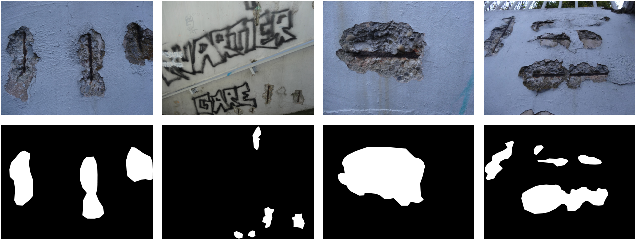
FIGURE 1 – Extrait du jeu d’apprentissage. Première ligne : images originales. Seconde ligne : Vérités terrain associées (un pixel blanc dans le masque indique un fer apparent dans l’image correspondante)
