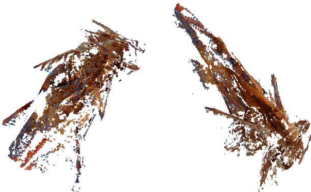
FIGURE 17 – Reconstruction 3D par MVS : deux vues du nuage de points 3D obtenu à partir de cinq images prises à travers la face avant, plus une prise de côté (cf. figure 15).
